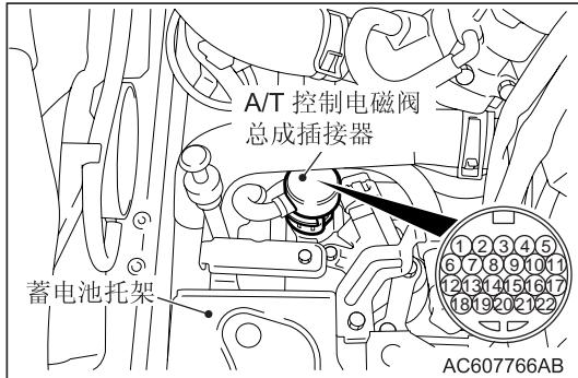
1. 断开 A/T 控制电磁阀总成插接器。
